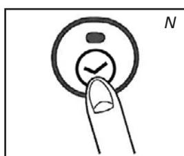
Ved hjelp av timeren kan varmeovnen slås på automatisk på et forhåndsinnstilt tidspunkt. For å kunne aktivere timeren må du ha stilt tiden riktig (se avsnitt C) og varmeovnen må være slått av. Følg fremgangsmåten nedenfor:
