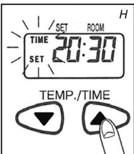
**2** Tryk på knapperne (▼) eller (▲) **20** for at indstille tiden. Tiden viser tallene 00:00 til 23:59. Tryk på knappen (▲) for at gå fremad og knappen (▼) for at gå tilbage. Klokkeslættet ændres i trin på et minut, hver gang du trykker på en af disse 2 knapper. Tiden på displayet ændres i trin på ti minutter, hvis du holder knappen nede (fig. H).
