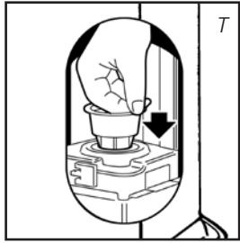
**3** Coloque el filtro del combustible en la estufa.
