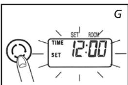
**1** Nacisnąć klawisz wybierania trybu **19** w celu ustawienia czasu (rys. G). Na wyświetlaczu miga czas ustawiony oraz czas.
