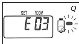
Hvis du ikke foretar deg noe, vil drivstofftanken tømmes og skjermen viser "E 03" (fig. Q). Varmeovnen slås av automatisk.
