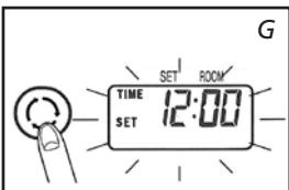
**1** Premere il pulsante mode **19** per la regolazione dell'ora. (la spia della regolazione dell'ora e il display dell'orologio lampeggiano) (fig. G).
