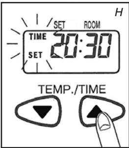
**2** Trykk på knappene (▼) eller (▲) ⑰ for å angi tiden. Tiden vises med numrene 00:00 til 23:59. Trykk på (▲) knappen for å gå fremover og (▼) knappen for å gå bakover. Tiden endres med ett minutt av gangen hver gang du trykker på én av disse 2 knappene. Tiden på skjermen endres med ti minutter av gangen hvis du holder knappen inne (fig. H.).
