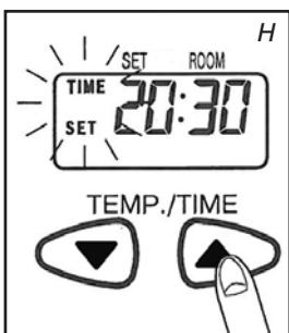
**2** S pritiskom na gumba (**▼**) ali (**▲**) **20** nastavite čas. Ura prikazuje številke od 0:00 do 23:59. Za naprej pritisnite gumb (**▲**), za nazaj pa gumb (**▼**). Vsakič ko pritisnete enega od teh 2 gumbov, se čas spremeni za eno minuto. Če gumb držite neprekiniteno, se čas na zaslonu spreminja po 10 minut (slika H).
