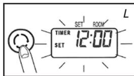
Med timeren kan kaminen tændes automatisk på et forud indstillet tidspunkt. For at kunne indstille timeren skal uret være rigtigt indstillet (se kap. C), og kaminen skal være slukket.
