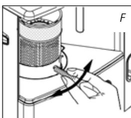
(fig. J). Slutt å fylle når måleren viser at beholderen er full. Beholderen må ikke overfylles, spesielt ikke når drivstoffet er svært kaldt (drivstoff utvider seg når det varmes opp).
