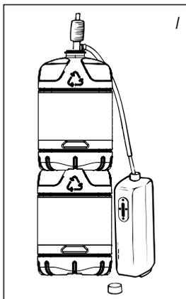
**3** Napolnite odstranljivi rezervoar s črpalko za gorivo (glejte navodila za ravnanje s črpalko za gorivo). Zagotovite, da je višje kakor odstranljivi rezervoar (slika H). Vstavite rebrasto gibljivo cev v odprtino odstranljivega rezervoarja.
