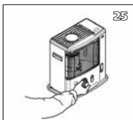
13. Faire descendre, en couissant, le régulateur de la mèche vers le bas, dans la conduite de tirage. Mettre l'arbre du régulateur à l'avant du poêle.
