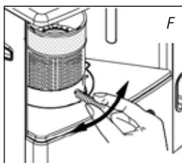
Verifique sempre após a ignição do aquecedor se a câmara de combustão ④ está bem posicionada, deslizando-a pelo manípulo ⑤ um pouco para a esquerda e a direita (fig. F). Proceda de forma suave. Quando a câmara de combustão estiver desnivelada, produzir-se-á fumo e fuligem.
