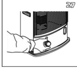
15. Element za nastavljanje stenja potisnite navzdol po cevi za zrak. Gumb za nastavljanje stenja usmerite proti sprednji strani grelnika.
