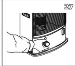
15. Deslice el regulador de mecha hacia abajo por el conducto de ventilación. Coloque el botón de regulación de mecha en la parte delantera de la estufa.
