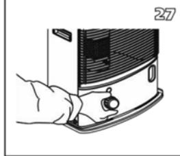
15. Far scivolare il gruppo di regolazione dello stoppino giù nell'aspiratore. Posizionare il dispositivo di regolazione nella parte anteriore della stufetta.
