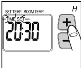
**1** Pressez le bouton mode **18** pour le réglage de l'heure. Le témoin du réglage de l'heure (time set) et l'affichage de l'horloge clignotent (fig. G).
