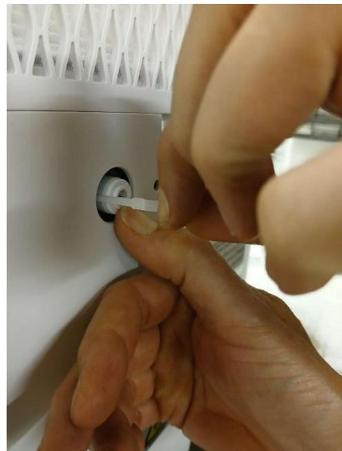
Vous pouvez maintenant retirer complètement le bouchon et placer le tuyau pour un drainage permanent. Bien enfoncer le tuyau pour verrouiller le raccord rapide
