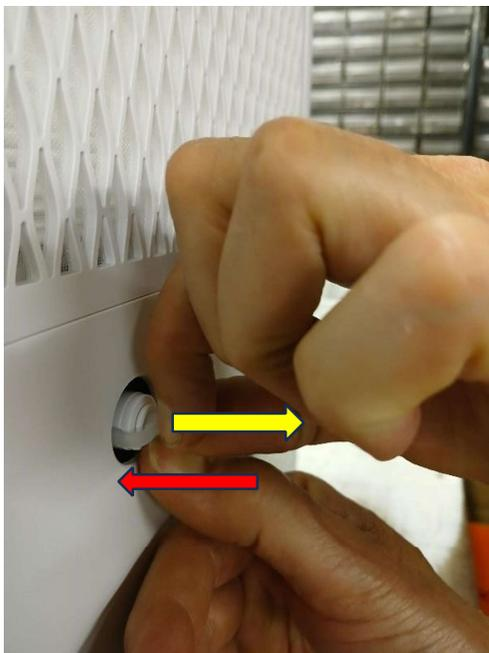
En poussant le petit anneau (flèche rouge), retirer le bouchon de l'appareil (indiquée par la flèche jaune) (si nécessaire, utiliser un petit tournevis plat).
