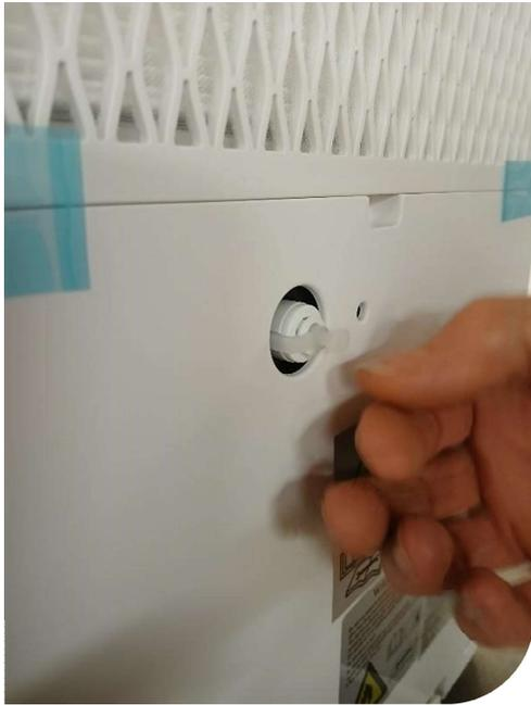
A l'arrière de l'appareil, près du filtre, vous trouverez le bouchon pour l'évacuation permanente de l'eau
